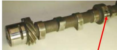
**Schmierbohrung (Ölaustritt) am mittleren Nockenwellen-Lager:** Öl fließt weiter zum Zylinderkopf
