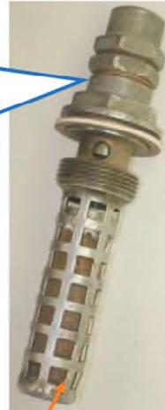
Der kleine Kolben und die dicke Feder sind auch bei den seitengesteuerten Motoren im 500 (A) verwendet worden. Das Überdruckventil sitzt dort aber unterhalb des vorderen Hauptlagers, es kann nur nach Abnahme der Ölwanne ausgebaut werden.
